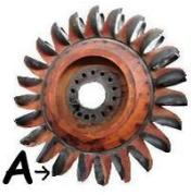
Dans la turbine, l'eau arrive en A et fait tourner la roue à augets dans le sens [horlogique - antihorlogique]
